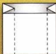
Simple soudure avec soufflets
